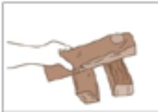
Hochwertiges, trockenes Stückholz oder Holzbriketts locker in den Brennraum schichten. Dabei darauf achten, dass der Brennraum nicht überfüllt ist.
